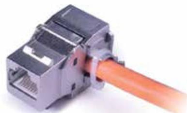
Этот модуль формата кейстоун совместим со стандартными экранированными модулями Molex DataGate, что позволяет построить линию с применением экранированных патч-панелей с модулями DataGate и установить модуль кейстоун в розетках рабочей зоны. Модуль не оснащается защитной шторкой. Этот продукт обладает прекрасной защитой от электромагнитного излучения, так как его экранирование выполнено в формате 360 градусов.
